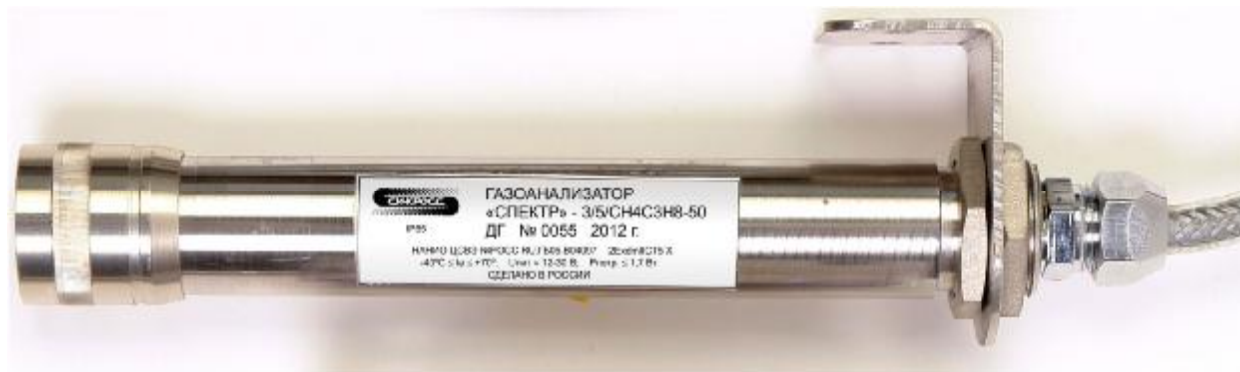
Рисунок 1 – Внешний вид датчика газоанализатора (ДГ) «СПЕКТР»
