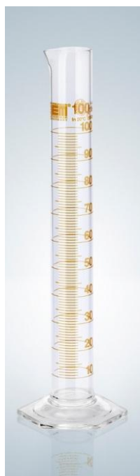
Рисунок 1 - Общий вид цилиндров класса точности А и В высокой формы с носиком и стеклянным основанием (знак ISO и USP)
