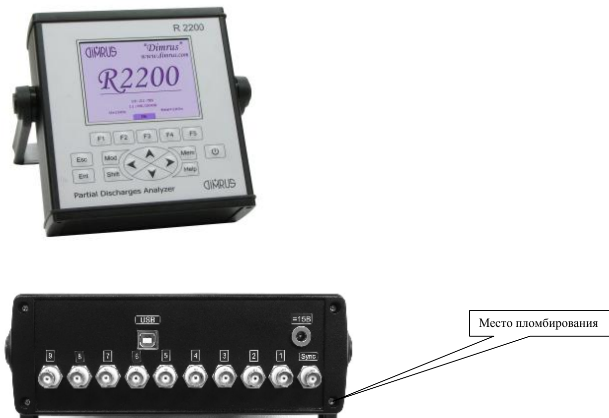
Общий вид измерителей частичных разрядов в изоляции «R2200»
