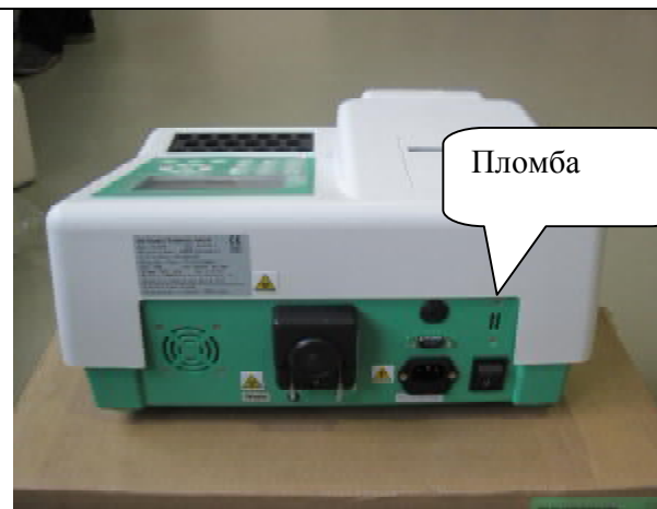
Рисунок 2 – Расположение пломбы. Анализатор полуавтоматический биохимический модели BS3000P
