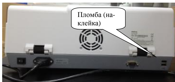
Рисунок 2 – Расположение пломбы. Фотометры микропланшетные MR-96А
