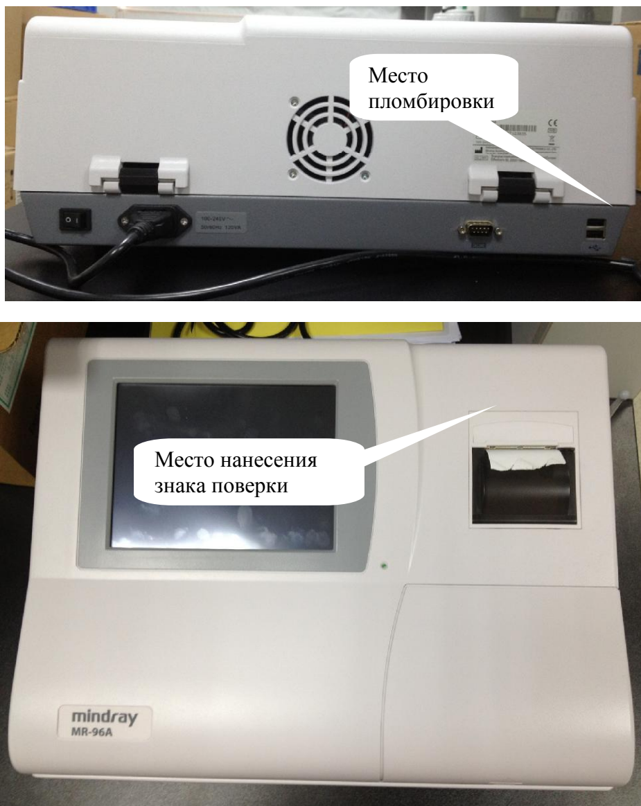
Рисунок 2 – Схема пломбировки от несанкционированного доступа и место нанесения знака поверки
