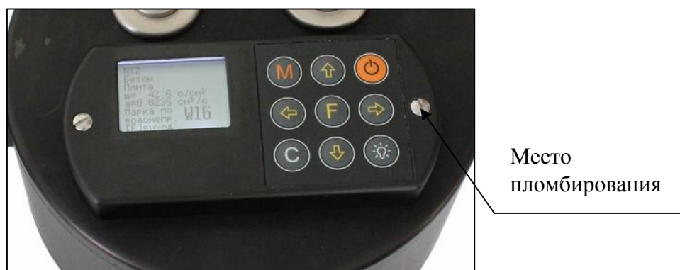
Рисунок 1 - Место пломбирования и клеймения на приборах модификации ВИП-1.1
