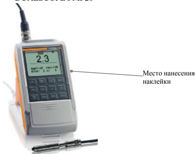
Рисунок 3. Внешний вид толщимера DELTA SCOPE FMP30, ISOSCOPE FMP30, DUALSCOPE FMP40 и место нанесения наклейки.
