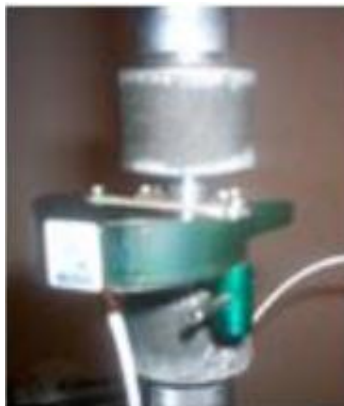
Рис. 1. Датчики перемещений (деформаций) АС-07-3000.
