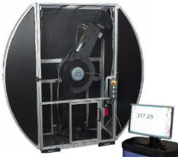
Рис. 1. Внешний вид копров маятниковых МРХ
