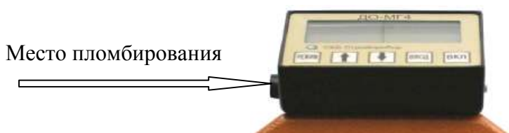
Рисунок 1 – Место пломбирования от несанкционированного доступа
