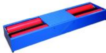
Рисунок 1 – Стенды силовые роликовые тормозные MBT 2XXX/IW 2 – легковые
