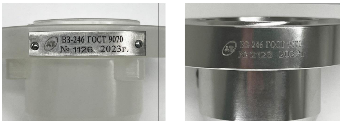
Пример маркировки вискозиметра из полипропилена
