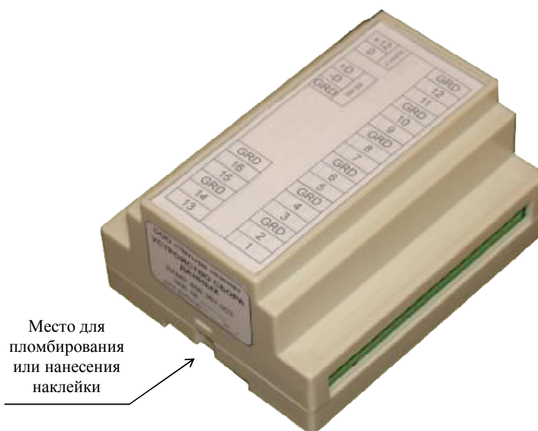
Рисунок 1 Фото общего вида УСД «ИЗУМРУД plus » с обозначением мест для пломбировки и оттисков клейм или наклеек
