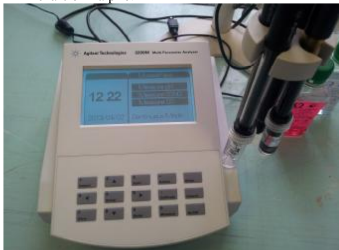
Рис.1. Внешний вид анализаторов жидкости моделей 3200M, 3200P, 3200I, 3200C, 3200D. Вид спереди.
