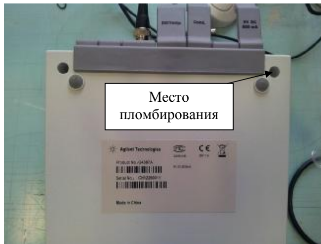
Рис. 2. Внешний вид снизу анализаторов жидкости моделей 3200M, 3200P, 3200I, 3200C, 3200D. Вид пломбы.
