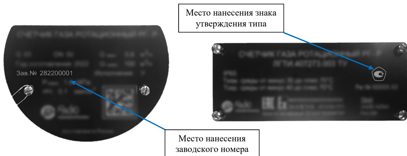
Рисунок 3 – Места нанесения заводского номера, знака утверждения типа для счетчиков в исполнении «Б» и «К»
