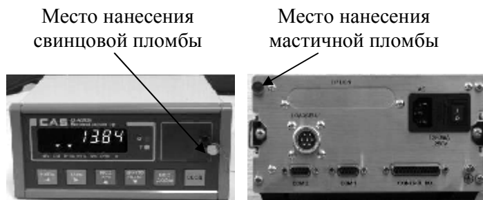
Рисунок 7 – Схема пломбировки прибора весоизмерительного (индикатора) СИ-6000А
