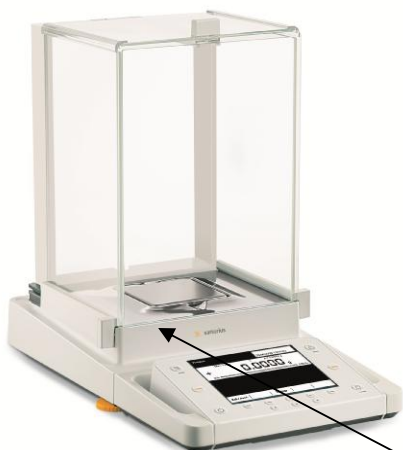
Рисунок 3а – Весы со взвешивающим модулем с d < 0,001 г и модулем терминала MSU
