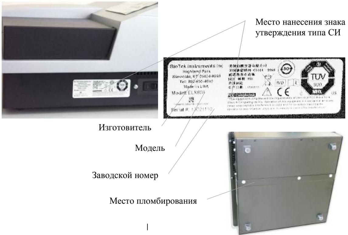
Рисунок 2 – Схема маркировки и пломбировки
