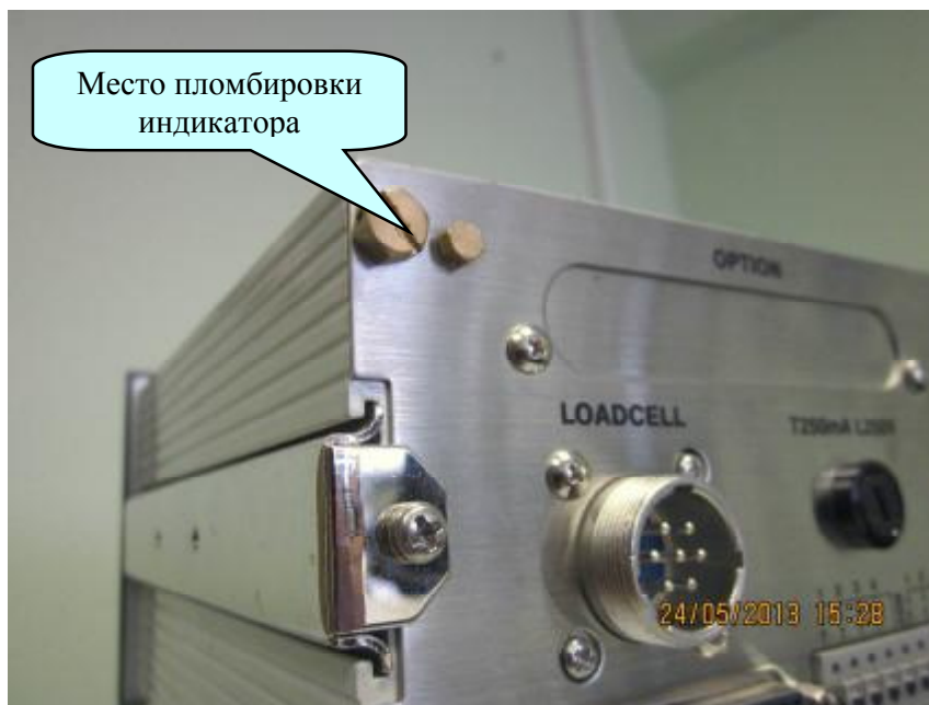
Рисунок 2 Схема пломбировки от несанкционированного доступа в настройки индикатора CI 5010A
