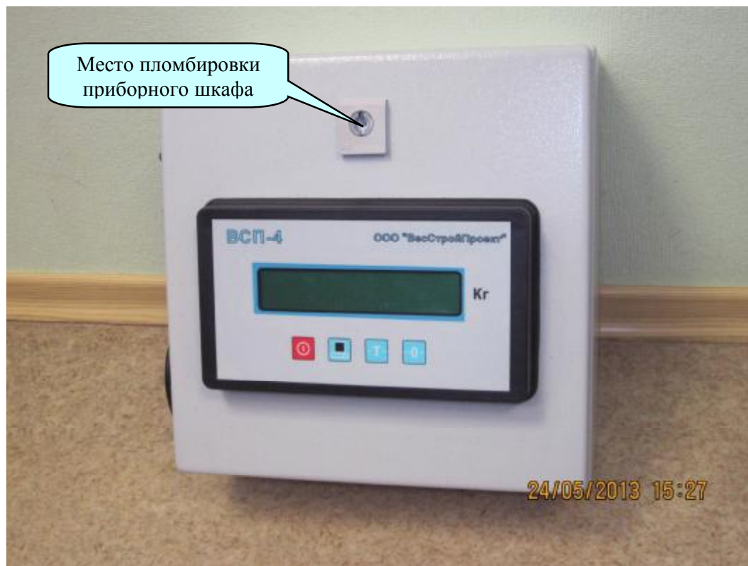
Рисунок 3 Внешний вид индикатора VСП-4 в приборном шкафу ТНМ-55-30.30.15 и схема пломбировки от несанкционированного доступа
