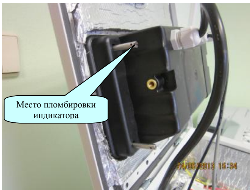
Рисунок 1 Схема пломбировки от несанкционированного доступа в настройки индикатора ВСП-4
