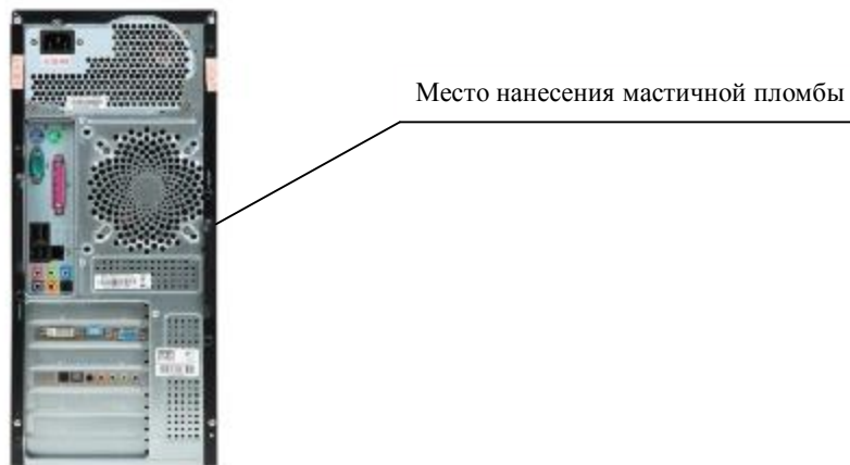
Рисунок 4 – Схема пломбировки системного блока ПЭВМ.
