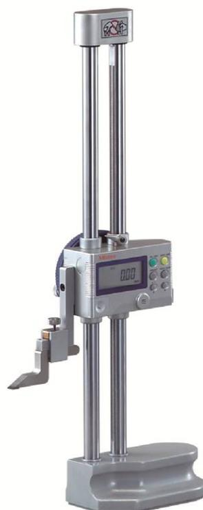
Рисунок 6 – Общий вид штангенрейсмасов серии 192 исполнение II
