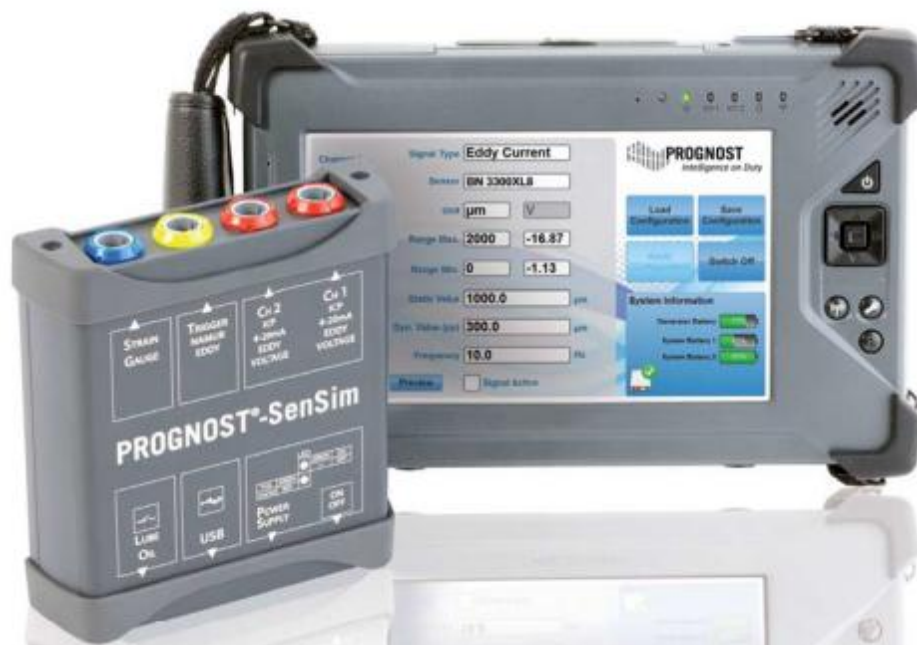
Рис. 1 Внешний вид имитатора сигналов преобразователей PROGNOST-SenSim.
