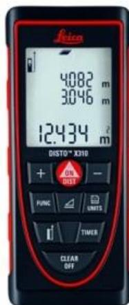
Опломбирование узлов дальномеров лазерных Leica DISTO X310 не производится, ограничение доступа к узлам обеспечено конструкцией крепёжных винтов, которые могут быть сняты только при наличии специальных ключей. Все внутренние винты залиты специальным лаком.
