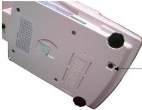
Место пломбировки с помощью разрушаемой наклейки (переключатель юстировки)
