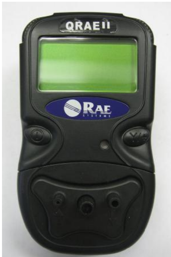
Рисунок 1 - Газоанализатор портативный многоканальный QRAE II
