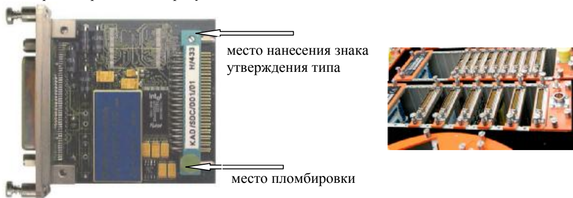
Рисунок 1 - Внешний вид модуля KAD/SDC/001 (КАМ/SDC/001) и модуля KAD/SDC/001 (КАМ/SDC/001), установленного в блок базовый КАМ/CHS
