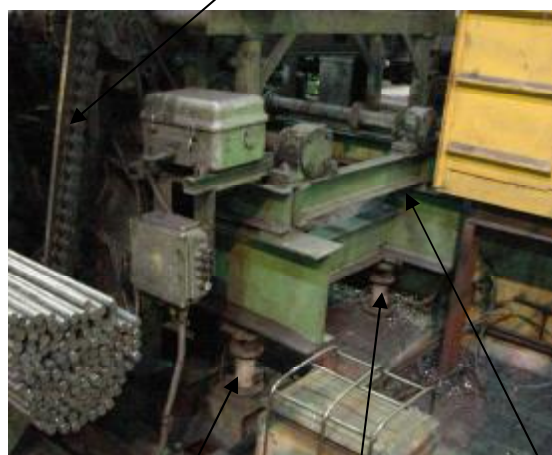
Места установки датчиков
