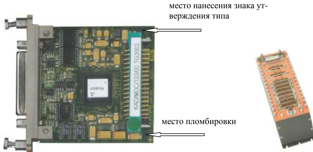
Рисунок 1 - Внешний вид модуля КАД/МДС/103 и модуля КАД/МДС/103 установленного в блок базовый КАМ/СНС/13U
