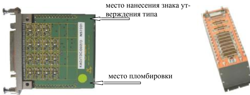
Рисунок 1 - Внешний вид модуля KAD/TDC/002/D и модуля KAD/TDC/002/D/10M установленного в блок базовый КАМ/СНС/13U
