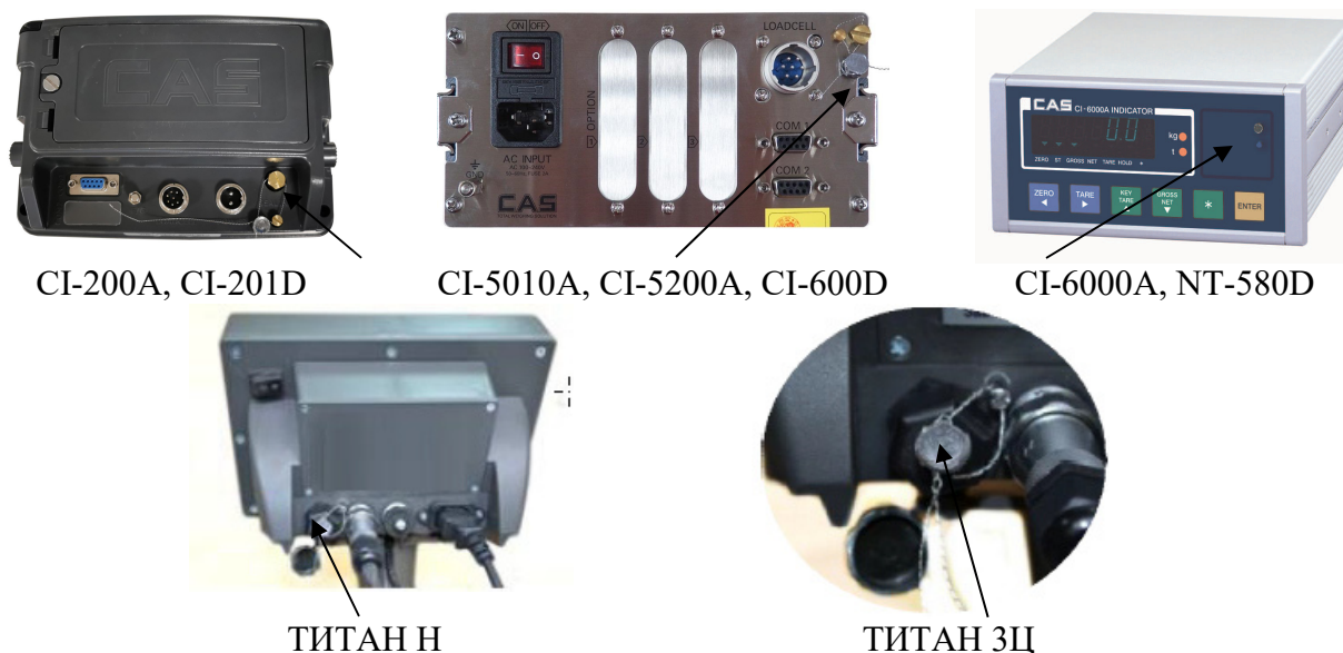
Рисунок 5 - Схема пломбировки от несанкционированного доступа и обозначение места для нанесения отиска клейма на пломбу
