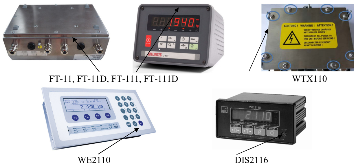
Рисунок 5 — Схема пломбировки от несанкционированного доступа с помощью разрушаемой наклейки и нанесения отиска клейма
