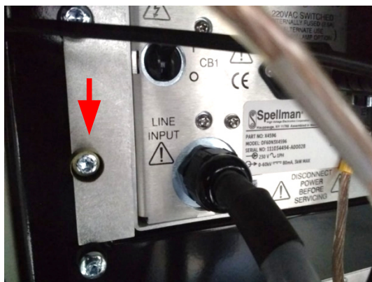
Чашка для пломбирования на задней панели ВИП
