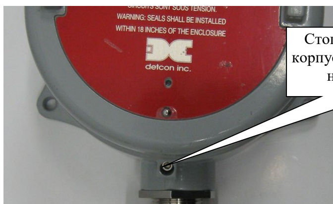
Рисунок 2 – Схема пломбировки газоанализаторов от несанкционированного доступа
