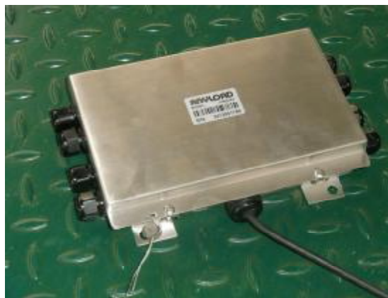
Рис. 4 – Место нанесения контрольного знака на блоке суммирования
