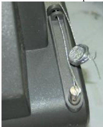
Рис. 3 – Место нанесения контрольного знака на задней крышке корпуса индикатора
