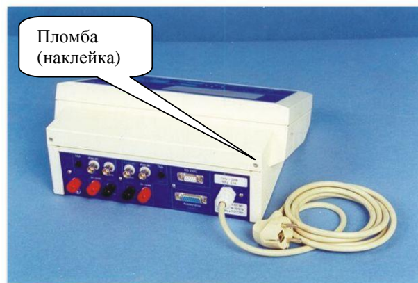
Рисунок 2 - Измерительный преобразователь прибора «АТОН-101 МП». Вид со стороны разъемных соединителей
