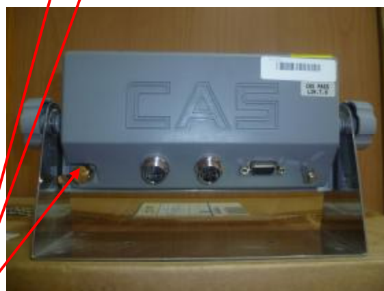
Места нанесения поверительных клеев
