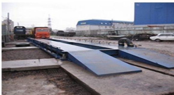
Рисунок 4- Общий вид весов неавтоматического действия (автомобильных электронных весов) тип BSA, наземное исполнение, колеяный металлический настил.
