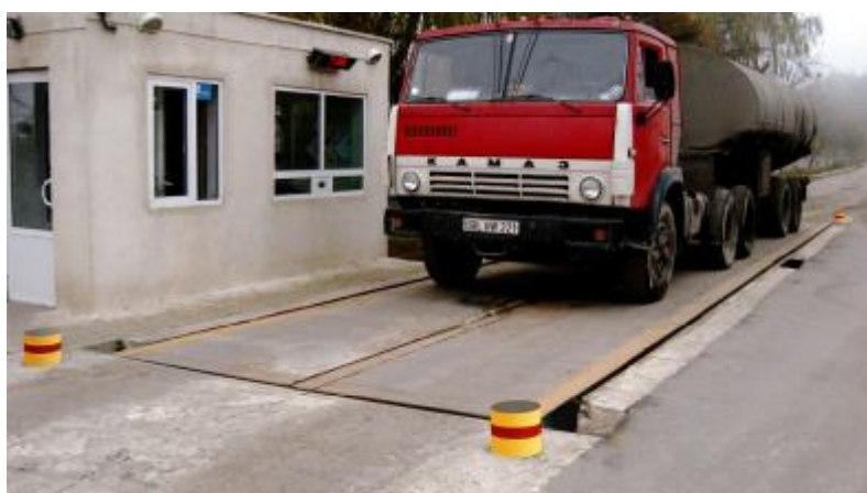
Рисунок 5- Общий вид весов неавтоматического действия (автомобильных электронных весов) тип BSA, исполнение в прямке металлический настил.
