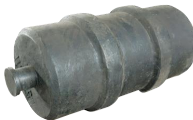
Рисунок 3 – Общий вид гирь с номинальным значением массы 500 кг классов точности M_1 , M_{1-2} , M_2 , M_{2-3} , M_3
