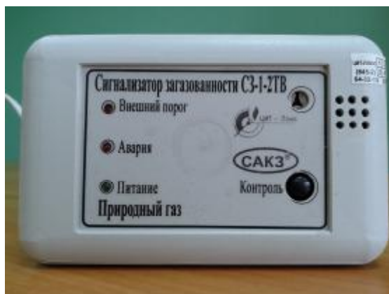
Рис.1 Фотография общего вида сигнализатора загазованности природным газом с оптическим сенсором СЗ-1Т.
