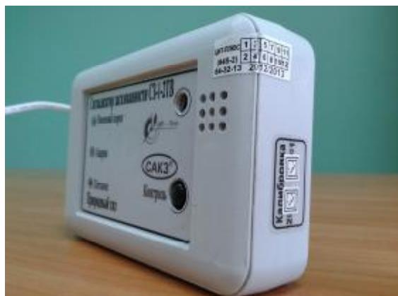
Рис.2 Фотография мест для пломбирования сигнализатора загазованности природным газом с оптическим сенсором СЗ-1Т.
