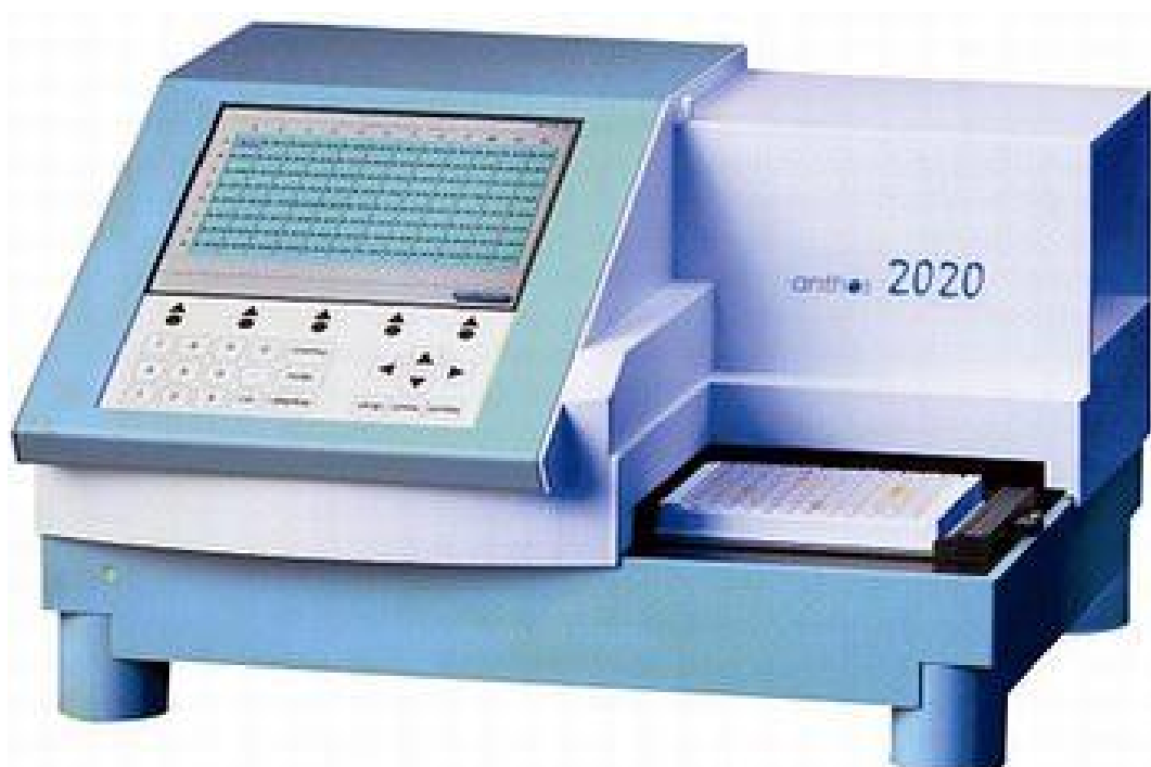
Рисунок 3 – Общий вид Фотометров микропланшетных «Anthos» моделей 2020
