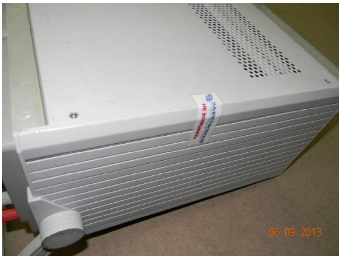
Рисунок 2 – Место нанесения легкоразрушаемой наклейки
