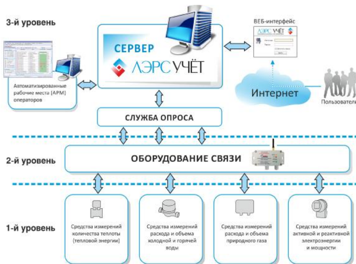
Рисунок 1 – Структурная схема АИС «ЛЭРС УЧЕТ»
