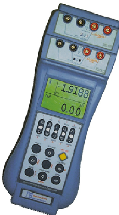
Рисунок 1 – Фотография общего вида калибратора
