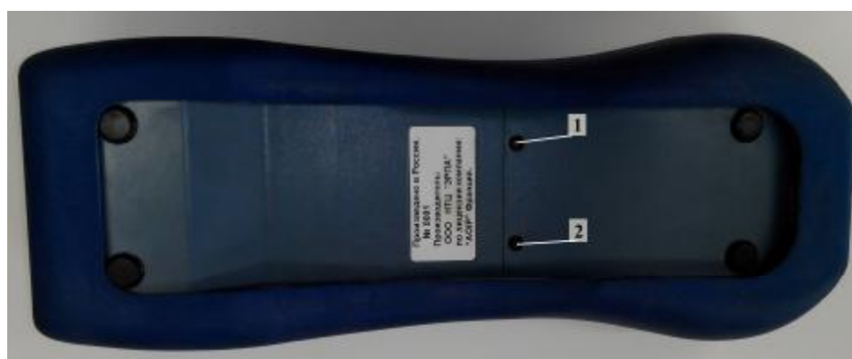
Рисунок 2 – Схема пломбировки калибраторов от несанкционированного доступа, где 1; 2 – места для нанесения оттисков клейм.
