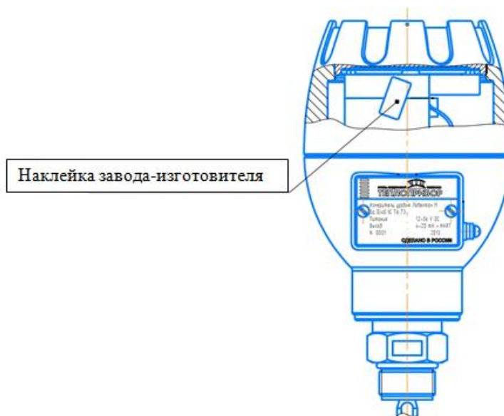
Рисунок 2 - Схема пломбировки от несанкционированного доступа, обозначение мест нанесения наклейки завода-изготовителя
