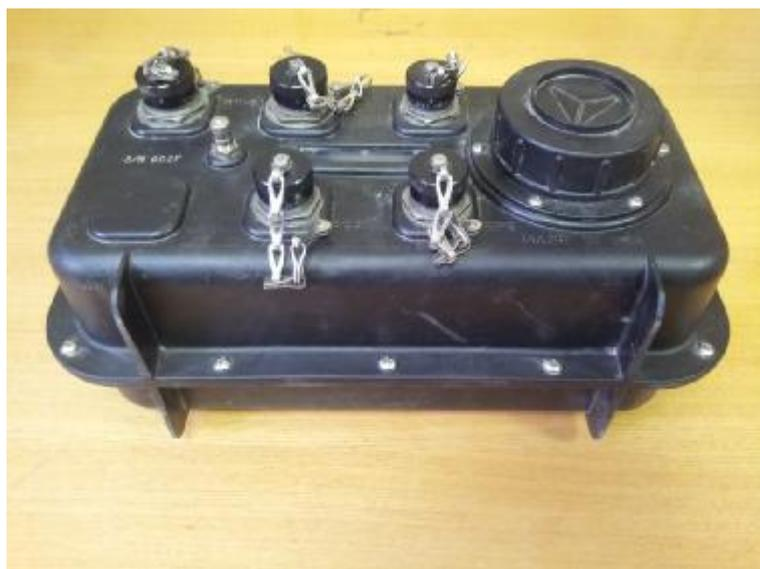
Рисунок 1. Общий вид регистраторов цифровых сейсмических Reftek-130, Reftek-130B
