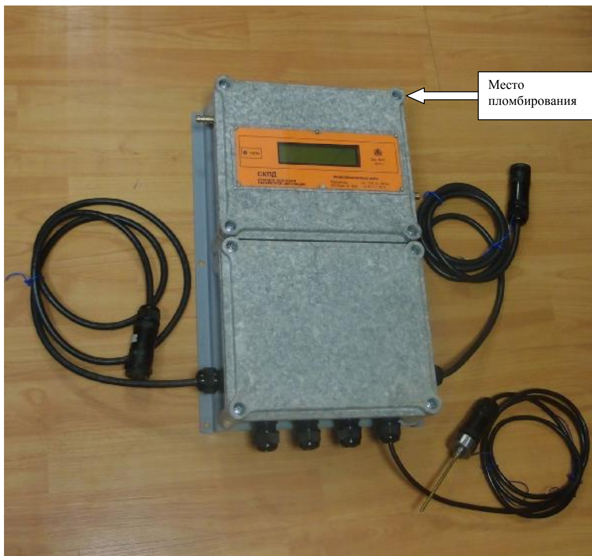
Рисунок 1 – Внешний вид станции контроля параметров дегазации СКПД
