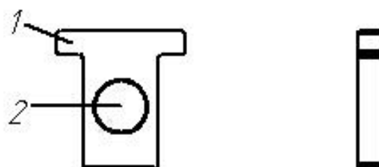
Рисунок 3 – Внешний вид меры оптической, входящей в состав набора мер МО-82-2 (1 – оправа, 2 – светофильтр)
