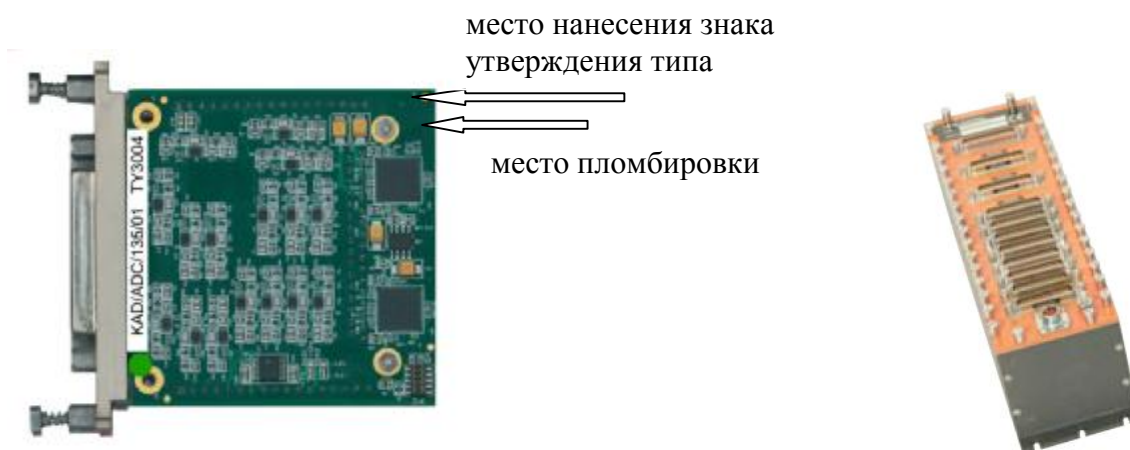
Рисунок 1 - Внешний вид модуля КАД/АДЦ/135/Е12 и модуля КАД/АДЦ/135/Е12 установленного в блок базовый КАМ/СНС/13U
