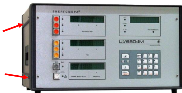
Рисунок 2 - Общий вид базового блока в корпусе системы «Евромеханика 19''» и схема пломбировки
