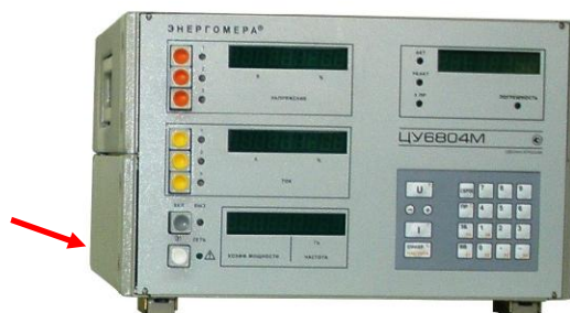
Рисунок 1 - Общий вид базового блока в корпусе стандарта УТК-2 и схема пломбировки
