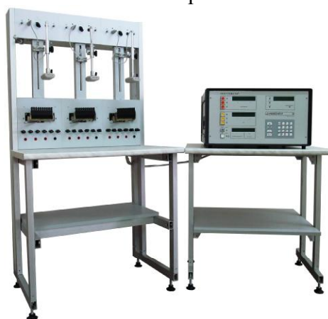
Рисунок 3 - Общий вид установки со стендом раздельного конструктивного исполнения с контактирующими устройствами на основе горизонтальных контактов
