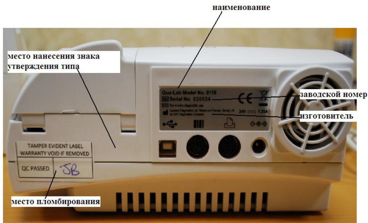
Рисунок 3 – Схема маркировки и пломбировки
